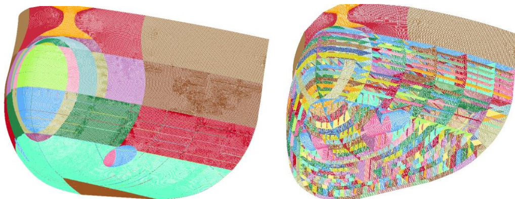
Figura 4 — Modelo numérico elaborado para porão/corpo paralelo do navio.
