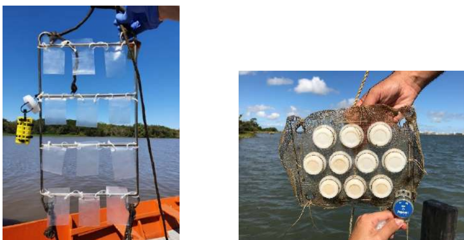
Figura 2 - Estrutura de exposição dos amostradores passivos: à esquerda para os microcontaminantes orgânicos e à direita para os metais-traço.
